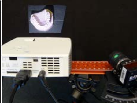
Abb. 4.3: Aufbau des Objekts und Ausrichtung von Projektor und Kamera
