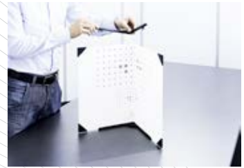
Abb. 4.6: Aufbau der Glaskalibrierflächen
