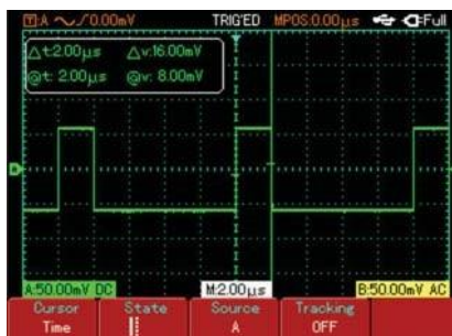
Abbildung 3-6 Messung der Impulsbreite mit den Cursorsn
