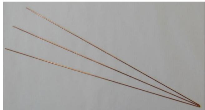
Abb. 9. Schweißdraht mit 2 mm Durchmesser ist preiswert und ist aufgrund seiner magnetischen Eigenschaft für die Fixierung in der Lötvorrichtung gut geeignet
